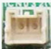
Kabel voor bediening van externe EC-ventilator.
